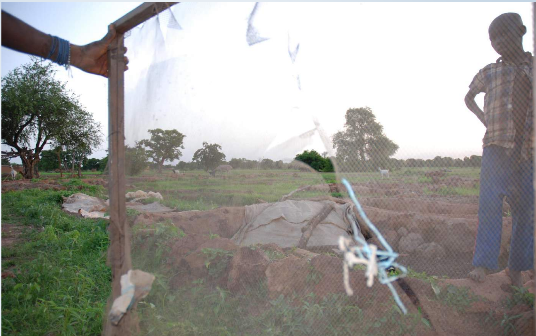
Tamis à compost avec grille détériorée
