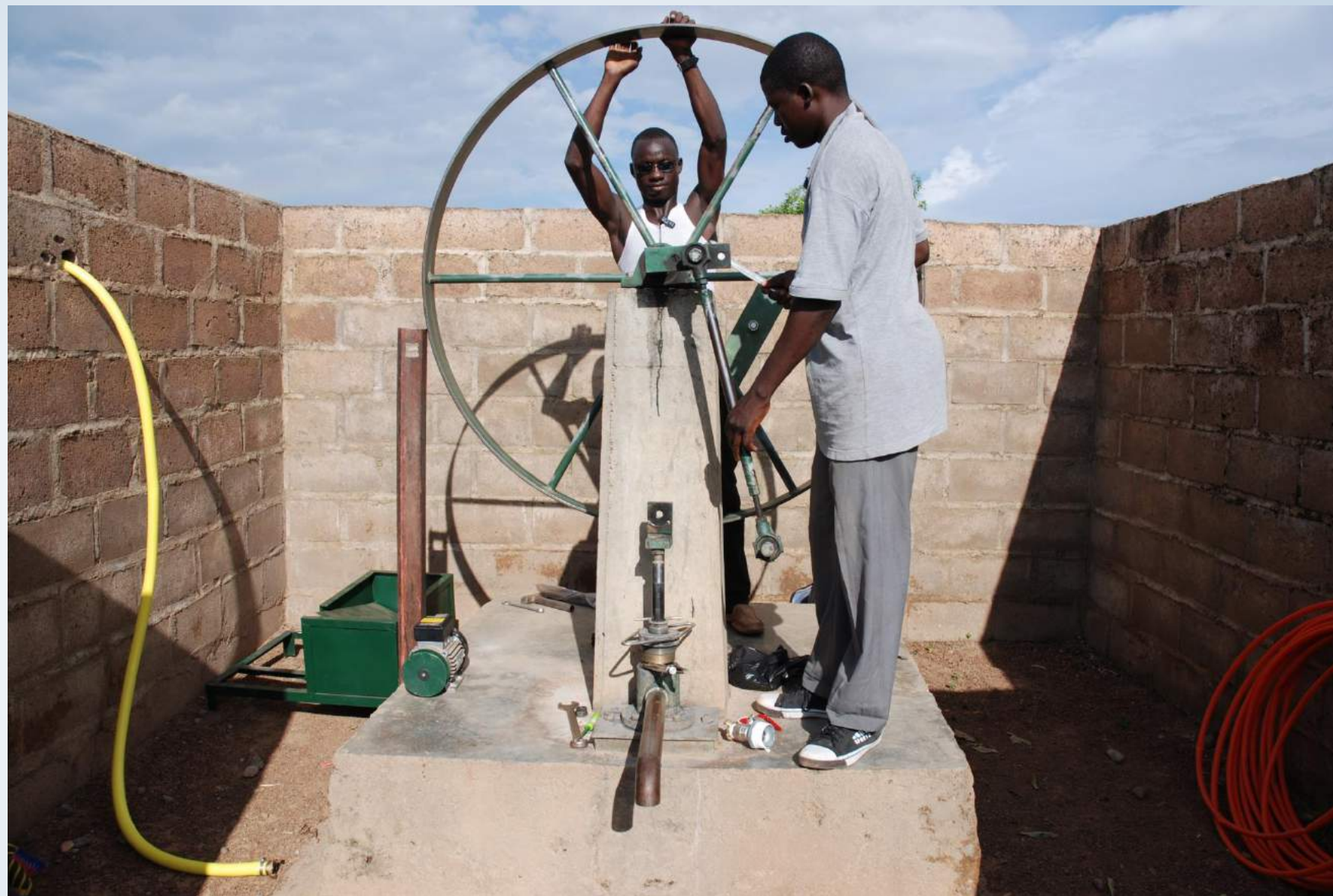
Equipement de la pompe Volanta avec le moteur électrique
