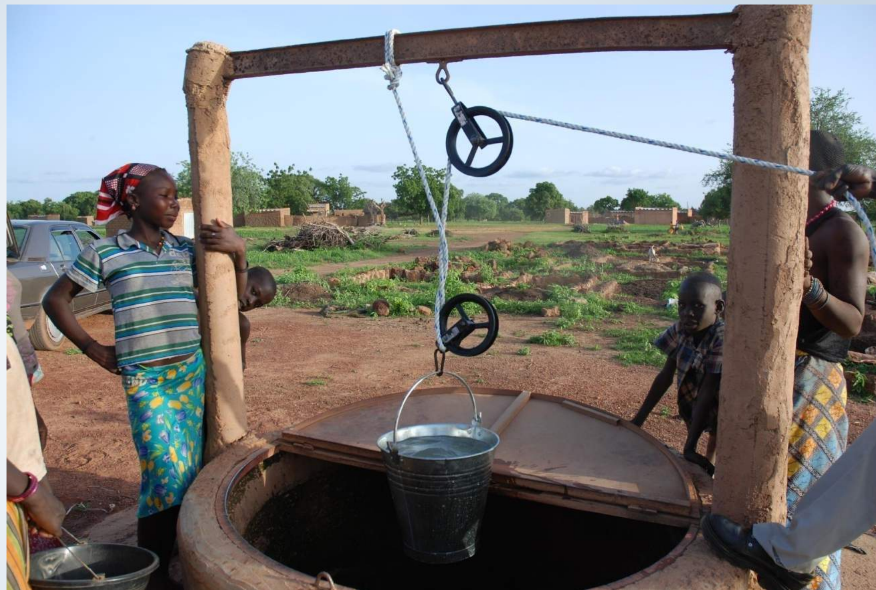
Essai de remontée d'eau du puits avec double poulie
