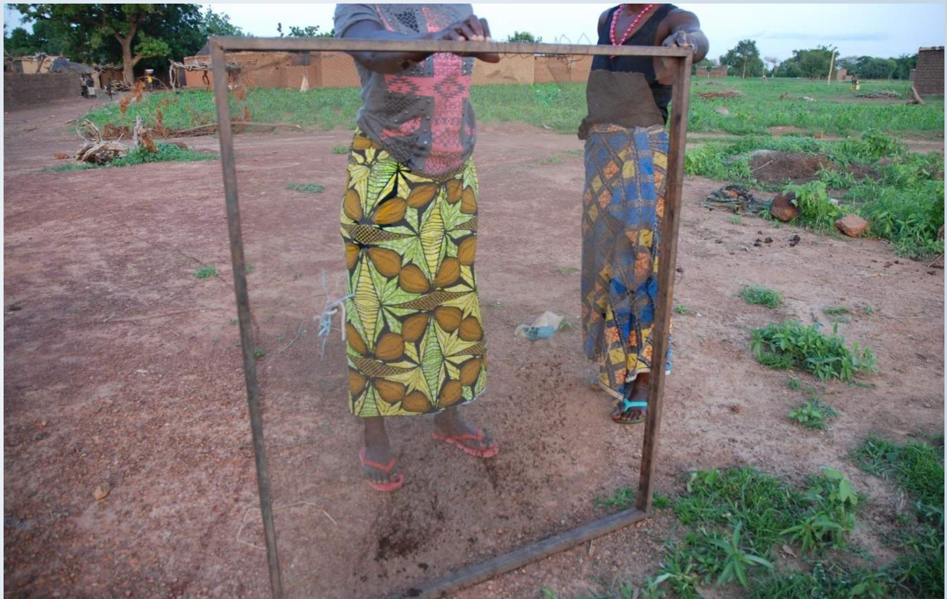
Tamis à compost avec cadre métallique et grille détériorée
