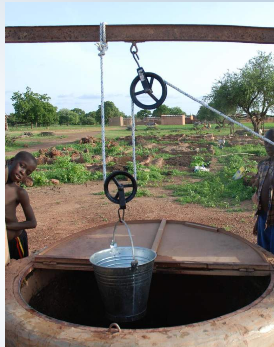
Essai de remontée d'eau du puits avec double poulie
